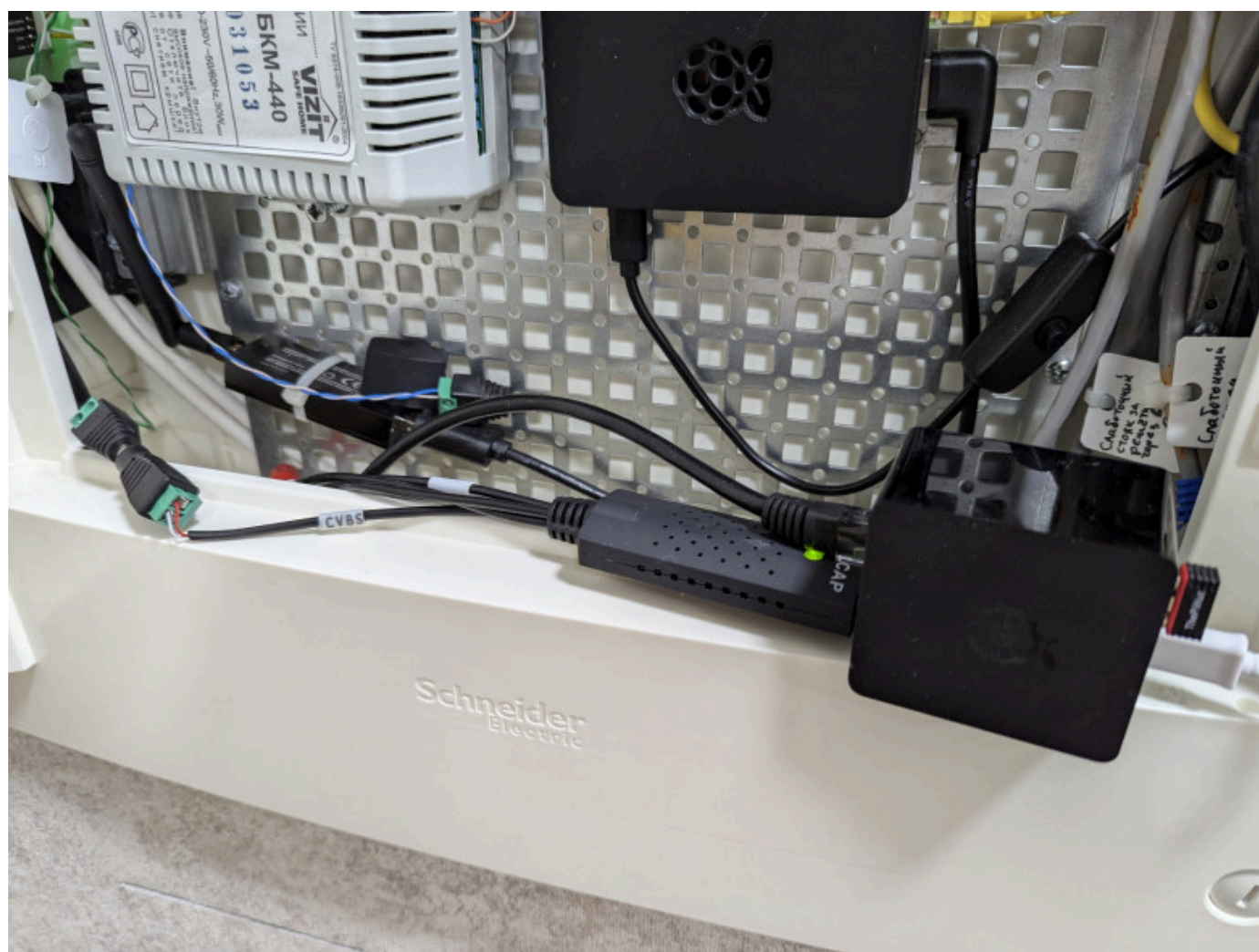
USB карта видеозахвата, подключенная к Orange Pi Zero 512Mb
